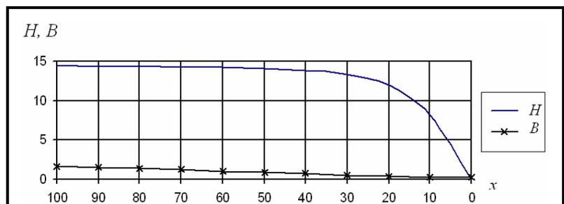
Рис.5. Оптимальные очертания ширины полок и высоты стенки двутаврового сечения балки
