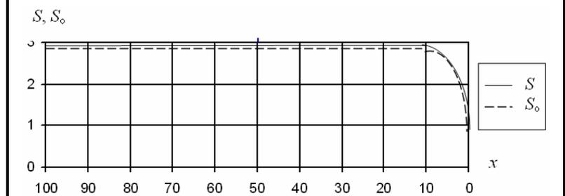
Рис.6. Оптимальное очертание начальной толщины полок двутавра и их вид в момент времени  $T_*$
