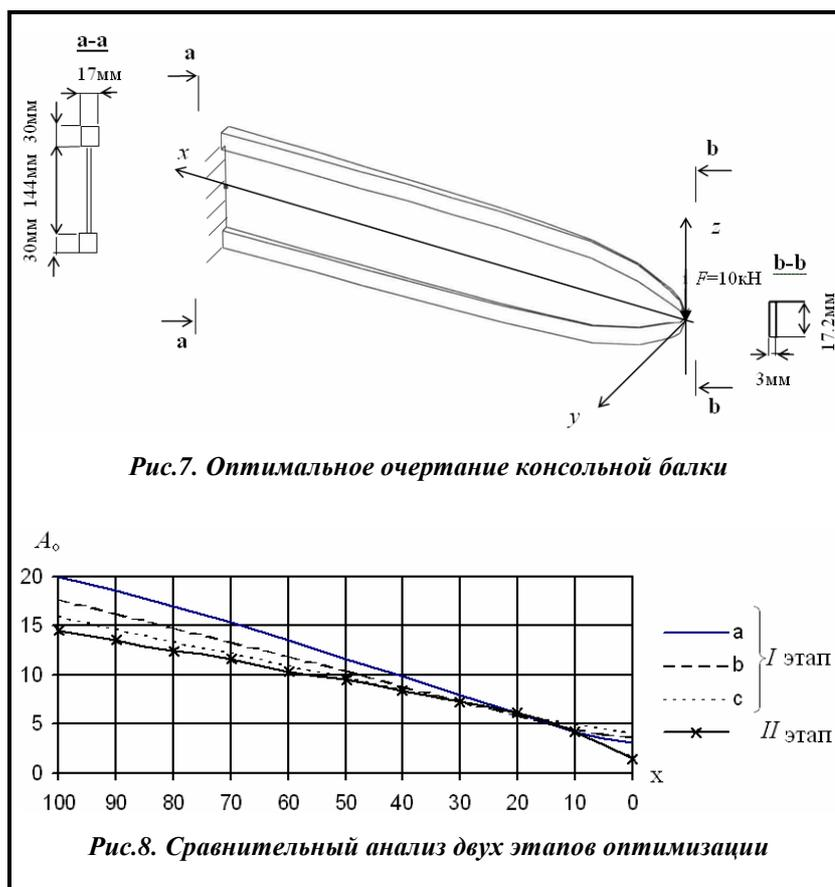
Рис.7. Оптимальное очертание консольной балки
