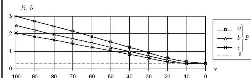
Рис.3. Оптимальное очертание ширины полки и толщина стенки двутаврового сечения балки
