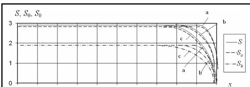
Рис.2. Оптимальные размеры начальной толщины полки и их вид в переходный и в конечный моменты времени
