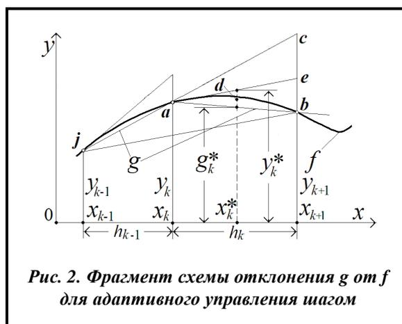
Другая возможность контроля за «максимальным» отклонением хорды  $\overline{ab}$  от дуги  $\widehat{ab}$  кривой  $f(x)$  (рис. 2) основана на наиболее вероятном расположении его в «срединной» окрестности дуги  $\widehat{ab}$ , т.е. когда ситуацию  $\sigma_k$  можно приближённо характеризовать, например, величиной отклонения
