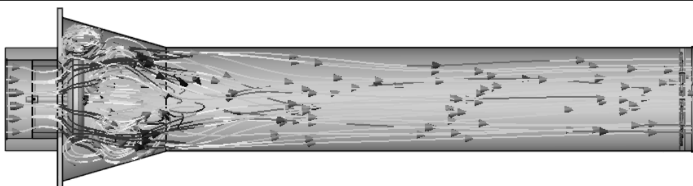
Рис. 4. Поля скоростей через анемостат, воронку и часть цилиндра для зазора 5 мм
