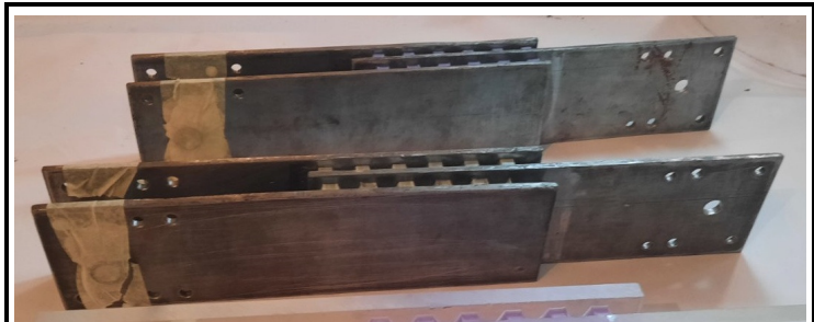
Рис. 3. Образці для испытаній на сдвиг сотового заповнювача з матеріалів PLA (вверху) і ULTEM 9085 (внизу)
