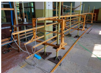
Рис. 1. Макет дволанцюгової ЛЕП із розташуванням проводів типу «діжка»
