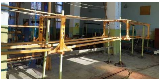
Рис. 2. Макет одноланцюгової ЛЕП із трикутним розташуванням проводів
