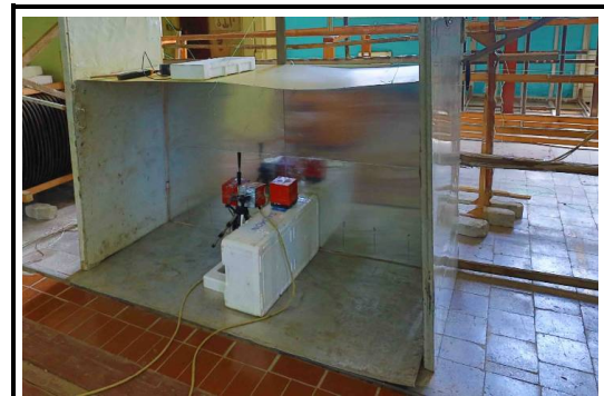
Рис. 17. Суцільний пасивний екран, в якого бічні поверхні пасивного екрана закриті листами з алюмінію
