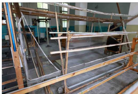
Рис. 3. Дві компенсаційні обмотки системи активного екранування
